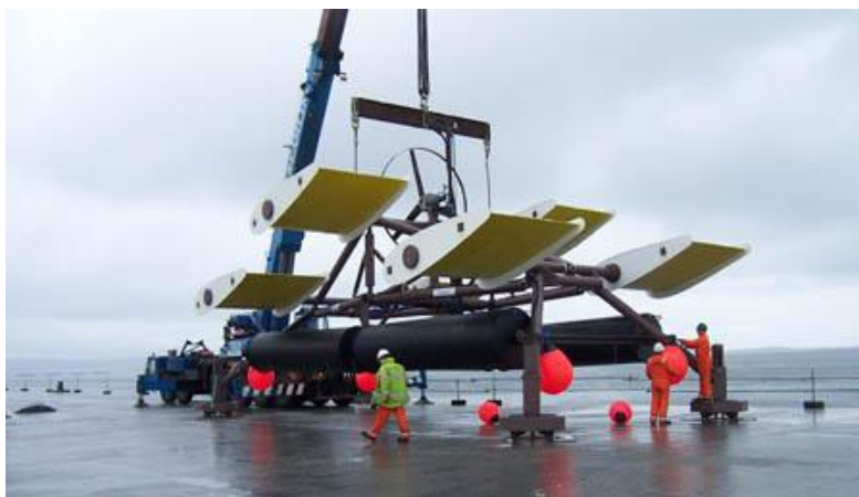
Obr. 10 – Zariadenie Sea Snail na využívanie energie morských slapov.
